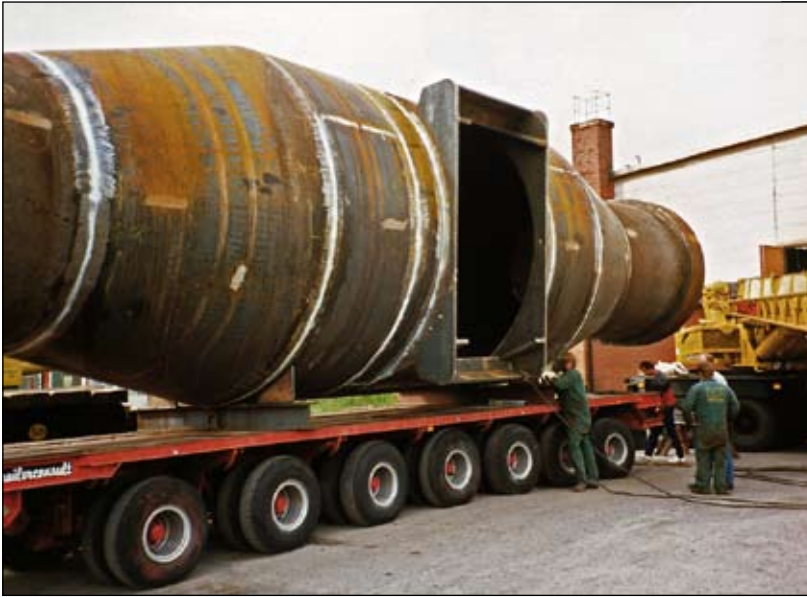
14 m lång 75 ton tung torped med diametern 4 m att transöportera flytande stål med i järnverket, levererad i början av 1990-talet. Foto Rolf Erlandsson
