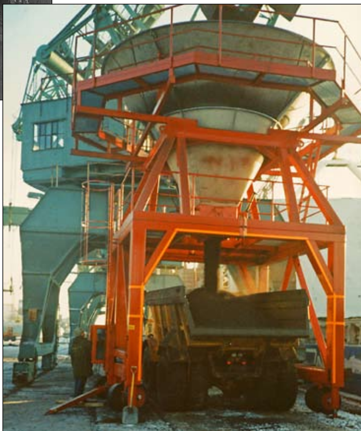
Omlastningsfickor som rymde 32 m 3 för hantering av kol och koks, levererad till Oxelösunds hamn 1985 - 86. Roland Lundh skissade och ingenjör Helenefors konstruerade. Fungerade bra med koks men kol och pellets fastnade. Foto Rolf Erlandsson
