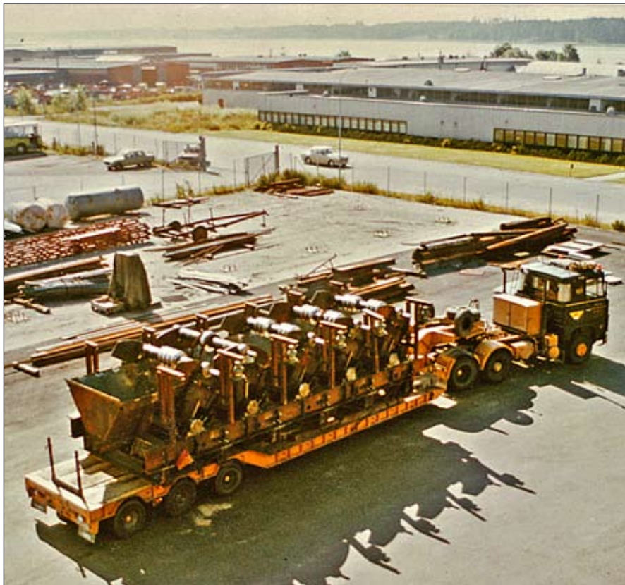
T v duckande rullbana 1980 levererad till SSAB för stränggjutning. Foto Rolf Erlandsson
